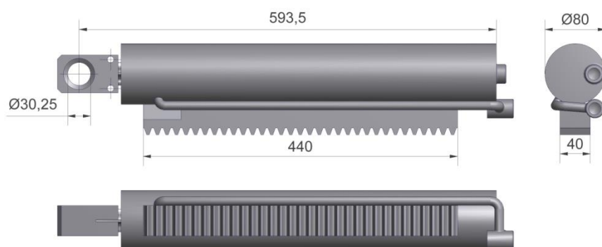
Figuur 3.1.4-Cilinder DW 70-30-420 M4 t.b.v. draaislag 200° (huidig model)
