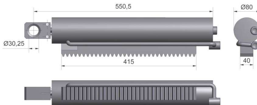
Figuur 3.1.1-Cilinder DW 70-30-377 M4 t.b.v. draaislag 180° (huidig model)
