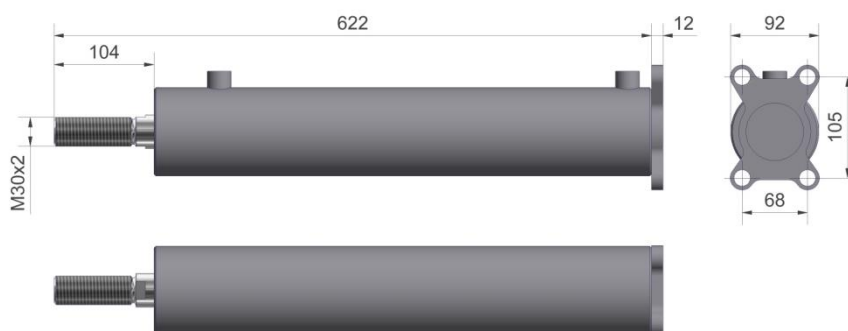
Figuur 5.1.1-Cilinder DW 80-35-377 t.b.v. draaislag 180°
