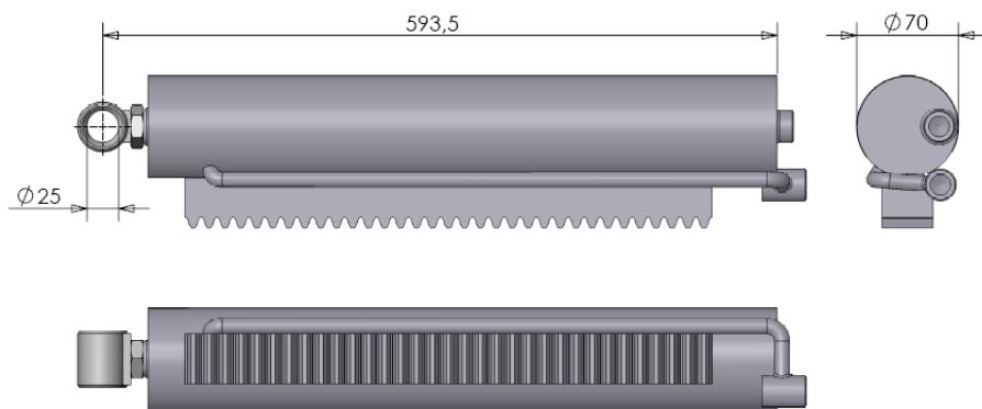
Figuur 3.1.5-Cilinder DW 60-30-420 t.b.v. draaislag 200° (oud model)
