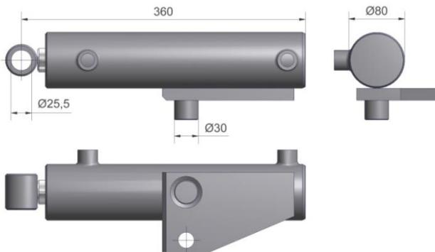
Figuur 3.2.3-Side-shift cilinder 70-30-200 (O.M)(Niet meer leverbaar)
