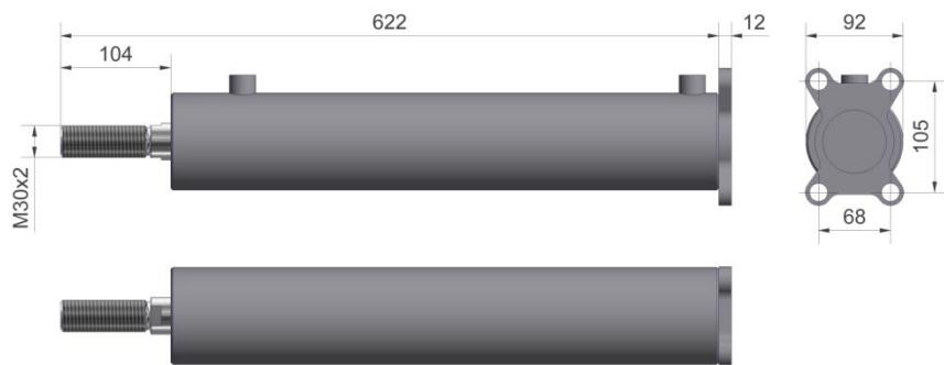
Figuur 5.1.1-Cilinder DW 80-35-377 t.b.v. draaislag 180°
