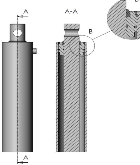
Figuur 2.2.2-Cilinder uitgevoerd met een gladde kop (GK)
