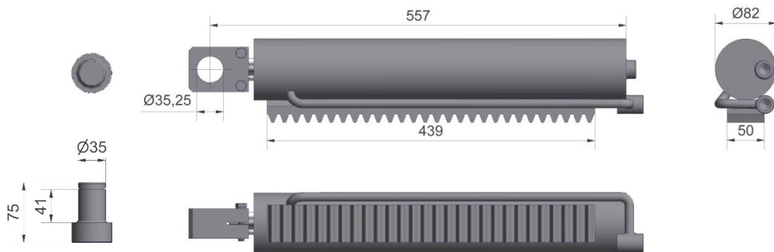
Figuur 4.1.1-Cilinder DW 70-30-377 M5 t.b.v. draaislag 180°
