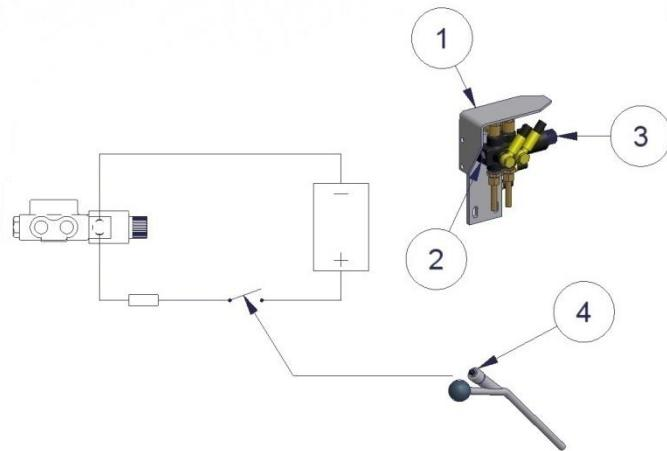
**Type: Elektrisch hydraulisch ventiel**
