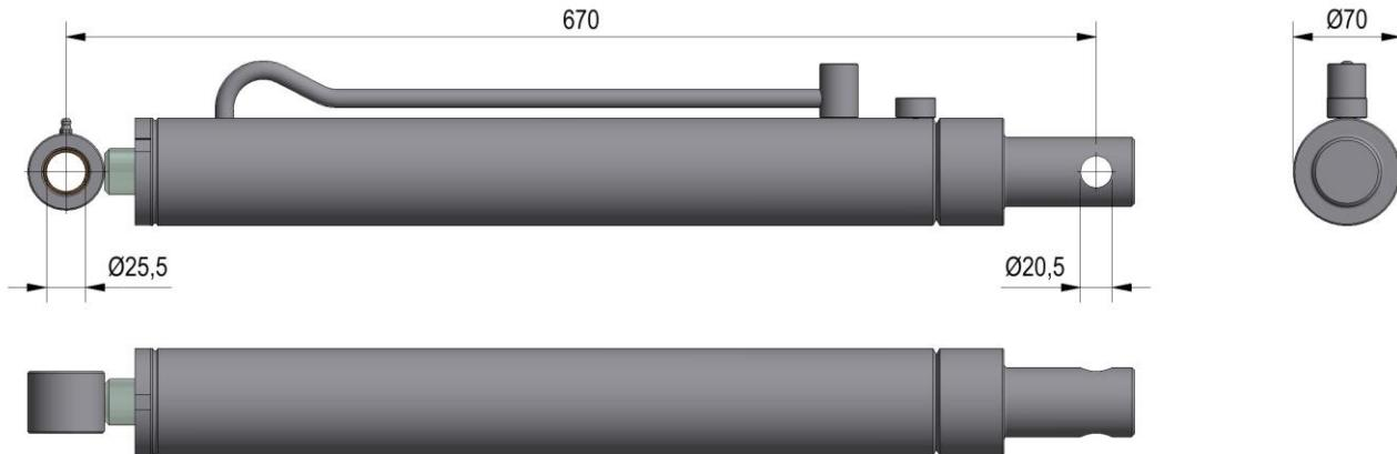
Figuur 12.1.7-Cilinder DW 60-30-410 (Huidig model)
