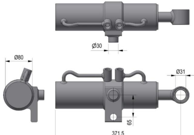
Figuur 4.2.3-Side-shift cilinder 70-30-200 Rechts
