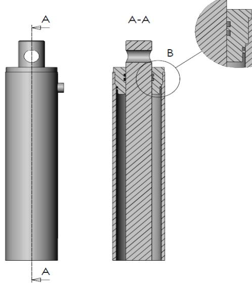
Figuur 2.2.1-Cilinder uitgevoerd met een schroefbare kop (SK)
