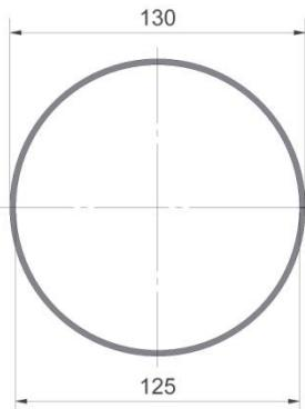
Figuur 3.3.6-Lagerbus teflon Ø125-L100
