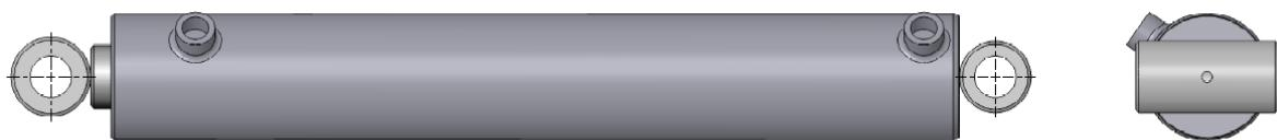
Figuur 12.1.3-Cilinder DW 70-40-410 rechter uitvoering
