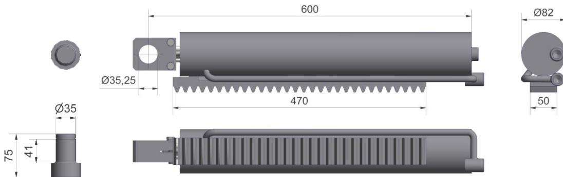
Figuur 4.1.2-Cilinder DW 70-30-377 M5 t.b.v. draaislag 200°
