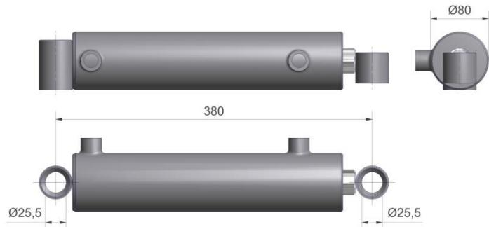
Figuur 3.2.5-Side-shift cilinder 70-30-200
