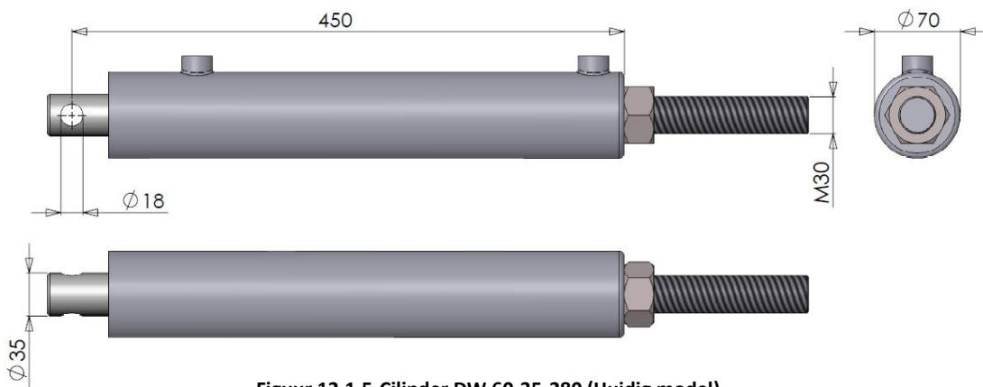
Figuur 12.1.5-Cilinder DW 60-35-280 (Huidig model)
