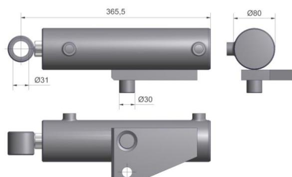
Figuur 3.2.1-Side-shift cilinder 60-30-200
