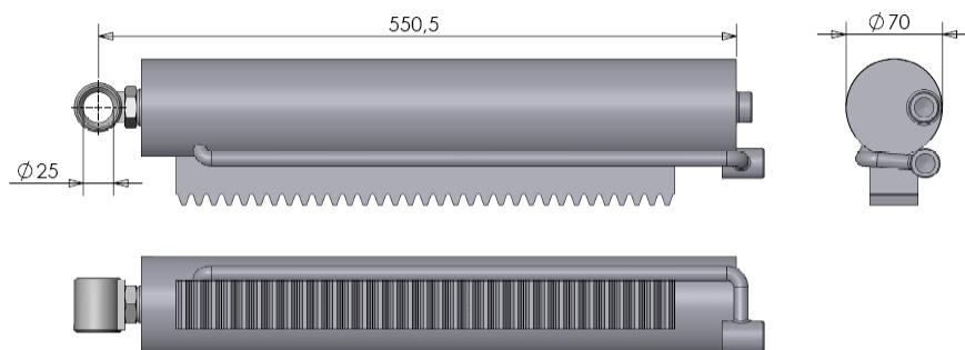
Figuur 3.1.3-Cilinder DW 60-30-377 t.b.v. draaislag 180° (oud model)
