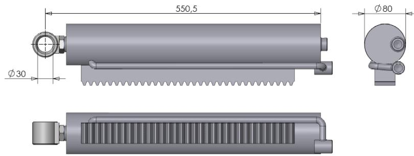
Figuur 3.1.2-Cilinder DW 70-30-377 t.b.v. draaislag 180° (oud model)
