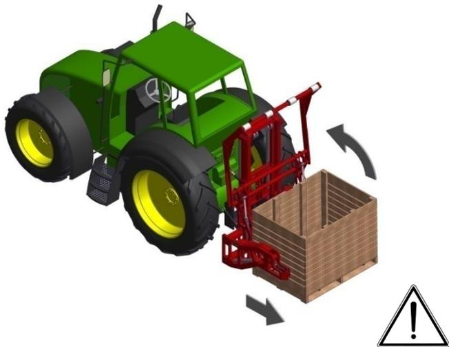
*Stellen Sie die Oberklemme mit dem Klemmzylinder hoch, bevor die Kiste mit dem Vornüber-Drehgerät aufgenommen wird.*
