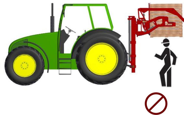
*Lassen Sie niemanden unter der Ladung stehen und halten Sie sich nicht im Dreh- und Kippbereich des Drehgeräts auf. Berücksichtigen Sie, dass Produkte aus der Kiste fallen können.*
