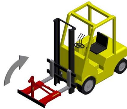
*Transportieren Sie den Geräteträger mit dem montierten Werkzeug so tief wie möglich, um das Transportwerkzeug so stabil wie möglich zu halten.*
