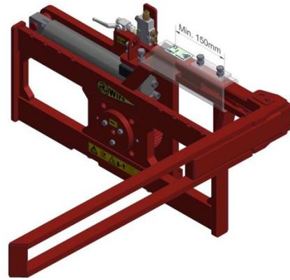
**Veillez à ce qu'une section de 150 mm (au moins) du positionneur de la fourche repliable soit bien dans l'entaille et bloquez-le correctement en serrant les deux boulons et les contre-écrous (140 Nm).**
