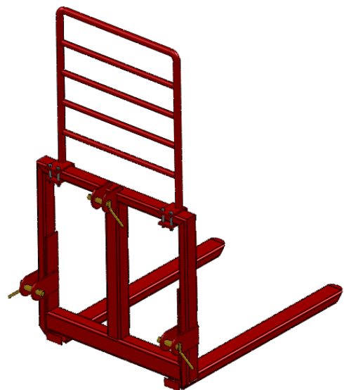
Figuur 2.4.2-P46-(A)/(B) met demontabele verhoging
